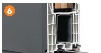
6 Skrzydło PVC 5 – komorowe o głębokości 82 mm ze stalowym wzmocnieniem zamkniętym o grubości 2 mm.
