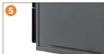
5 Innowacyjna, aluminiowa listwa dylatacyjna, zapewnia odpowiednią przestrzeń dla rozszerzalności termicznej zewnętrznej nakładki HDF. Dzięki temu skrzydło drzwi PVC jest odporne na wpływ wysokich temperatur, a komfort obsługi drzwi stawia je na równi z klasą aluminiowych drzwi premium.
